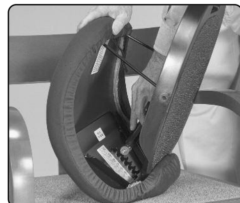
Seleccione una posición en el cilindro adecuada al usuario y centre el pistón entre las ranuras.
